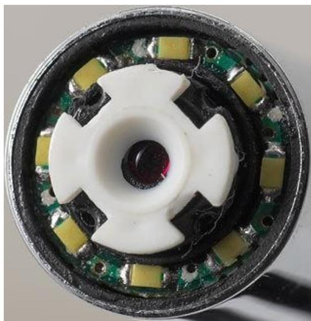
avec les quatre creux dans la plaque en se concentrant sur la surface de la lentille. Lorsque la bague de mise au point est tournée la lentille doit tourner, réglant ainsi le focus. Prêtez attention à ce que chaque partie de la fonction soit la même connexion que la lentille.
