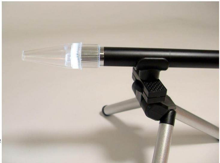
Lorsque la bague de mise au point est tournée, la lentille doit tourner, réglant ainsi le focus.
