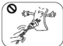
Ne pas utiliser l'appareil en cas d'état de somnolence, ne pas utiliser à l'extérieur ou dans un endroit où des aérosols (spray) sont utilisés ou dans un endroit où de l'oxygène est administré. Pour le débrancher, attraper la prise et ne pas tirer sur le cordon.
