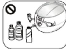
Ne pas remplir le réservoir avec des produits chimiques abrasifs ou corrosifs.
