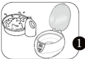
Après l'utilisation, verser l'eau et essuyer le réservoir et sa surface.
